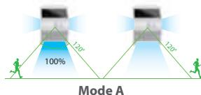
Al crepuscolo la lampada si accende alla massima luminosità quando viene rilevato un movimento entro un raggio di ≤6 metri, quindi si attenua per ridurre la luminosità (luce anteriore e luce posteriore entrambe accese) dopo 20 secondi di assenza di movimento.
