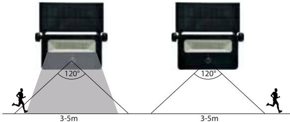
Al crepuscolo, la lampada si accende al massimo della luminosità per 30 secondi solo quando viene rilevato un movimento nel raggio di ≤5 metri.
