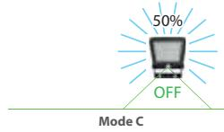
Al crepuscolo la lampada si accende a luminosità ridotta, il sensore di movimento non è attivo.
