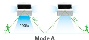
Al crepuscolo la lampada si accende alla massima luminosità quando viene rilevato un movimento entro un raggio di ≤6 metri, quindi si attenua per ridurre la luminosità (luce anteriore e luce posteriore entrambe accese) dopo 20 secondi di assenza di movimento.
