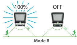
Al crepuscolo, la lampada resta spenta e si accende al massimo della luminosità per 15 secondi solo quando viene rilevato un movimento nel raggio di ≤10 metri.
