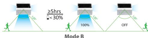
Al crepuscolo (<30 lux), La lampada si accende automaticamente e rimane al 50% di luminosità.
