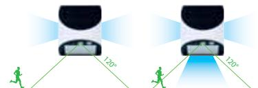
Al crepuscolo, la lampada accende le luci posteriori, la luce frontale si attiva al massimo della luminosità, per 15 secondi, quando viene rilevato un movimento.
