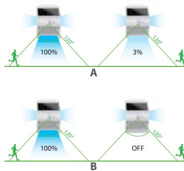
Al crepuscolo (<30 lux), la lampada si accende per 10 secondi alla piena luminosità quando rileva un movimento per poi ridursi al 3% della luminosità. La luce posteriore è sempre attiva.
