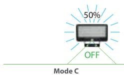
Al crepuscolo la lampada si accende a luminosità ridotta, il sensore di movimento non è attivo.
